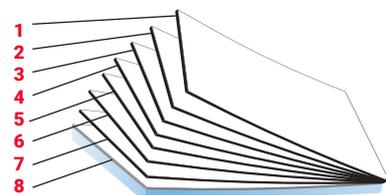
1. Couche dure résistante aux rayures courantes, permettant une bonne durabilité et facilité d'entretien lors du nettoyage des vitres
